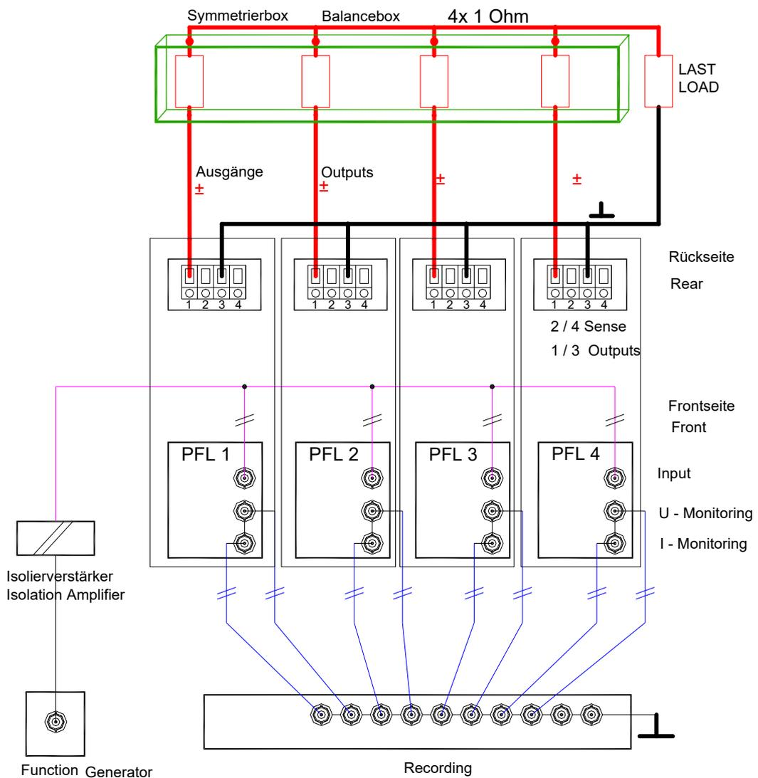
Um Erdschleifen und damit unkontrolliertes Schwingen zu vermeiden, ist es empfehlenswert erdfrei bzw. isoliert zu messen.
