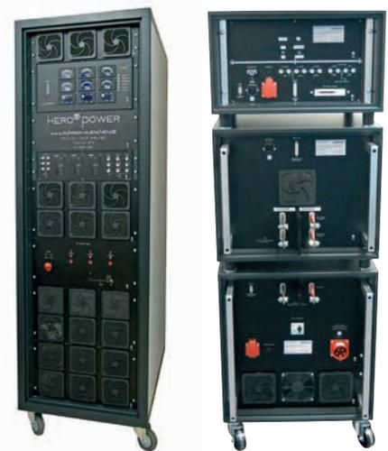
Links: HERO® - Leistungsverstärker überzeugen mit Dynamik, Leistung und Präzision. Rechts: 3-teiliges modulares Verstärkerkonzept für mobil einsetzbare Bordnetzsimulation
